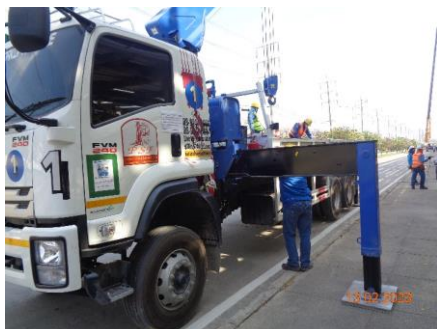
ภาพที่ 2-30 รถบรรทุกที่มีอุปกรณ์สำหรับการเคลื่อนย้ายท่อ
